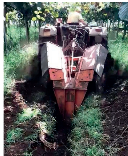
Affossatura con scarico terra sulla carreggiata
