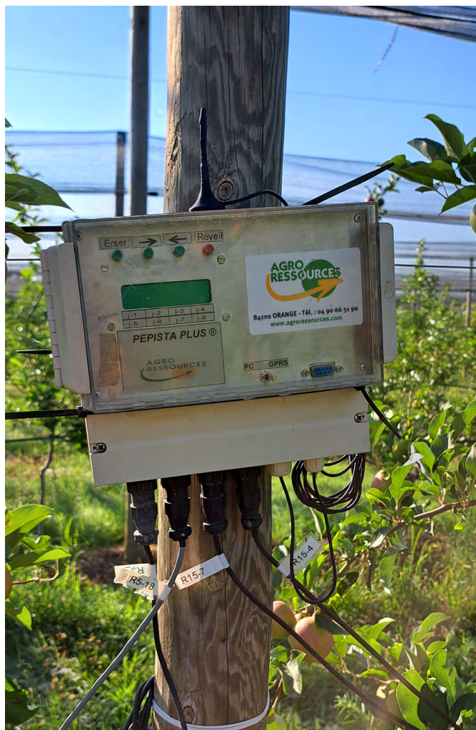
Centralina utilizzata per testare i diversi livelli di restituzione idrica
